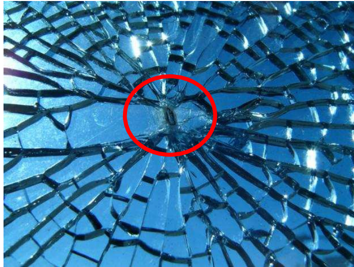
Imagen N°4 Patrón de Mariposa Típico de Ruptura Espontánea en el Vidrio Temperado
